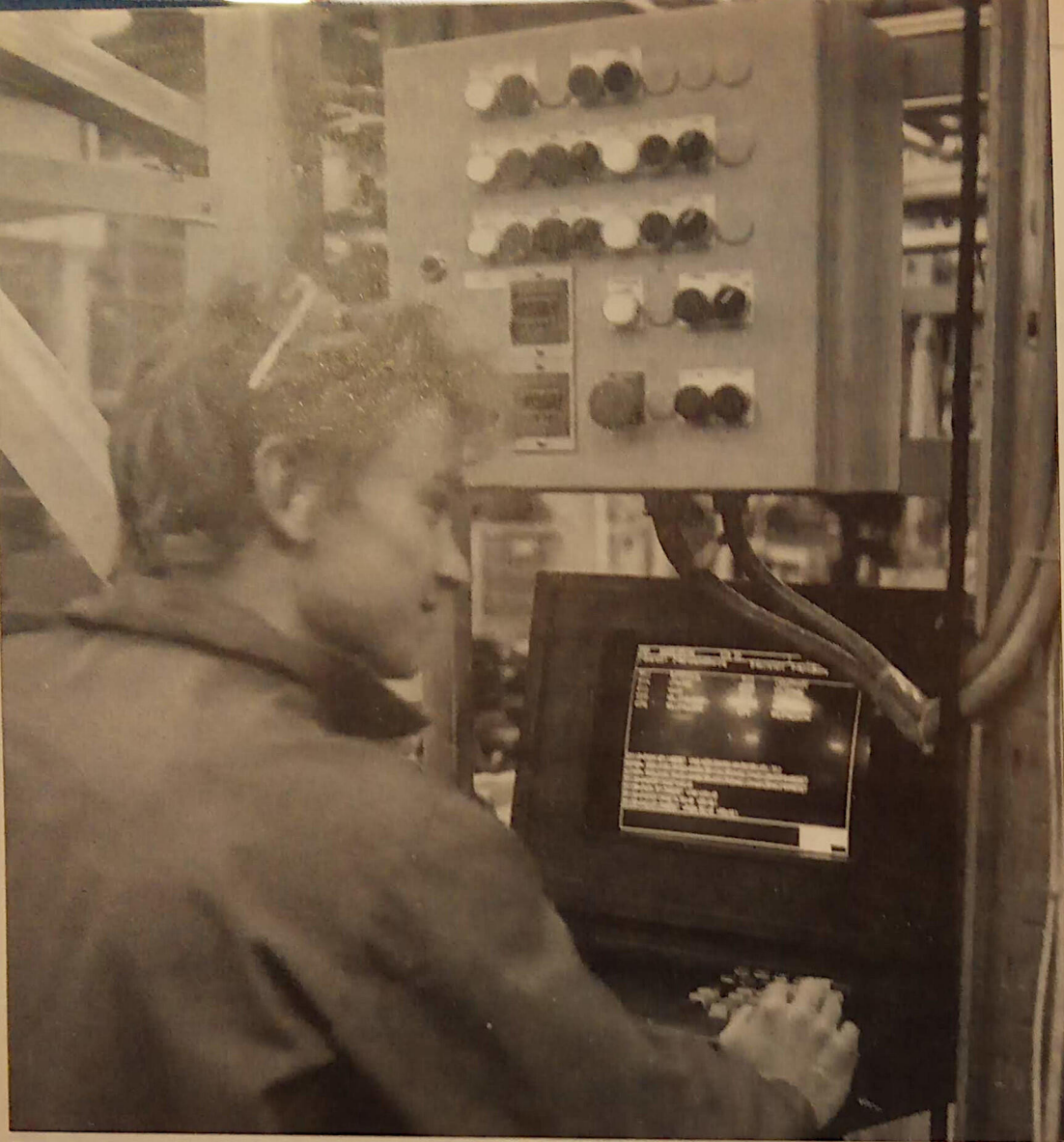
Bild 8. Industriterminalsystemet GOT presenterar styrprogrammen i klartext och översiktliga bilder.
