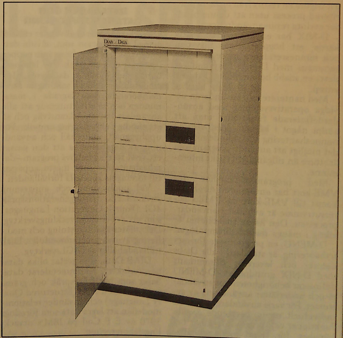
Bild 2. Kontorsmodellen, ovan, får plats under eller bredvid ett skrivbord, stativmodellen, t. h., har modulär konstruktion, vilket ger utbyggnadsmöjligheter.
