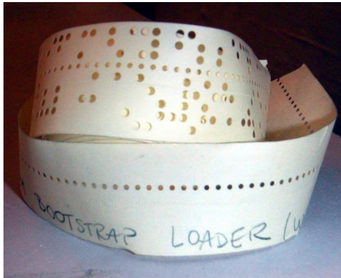
Figur 1.1: En hålremsa med en s.k. bootstrap-loader till en gammal dator av märket Hewlett-Packard.
